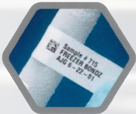
*ETIQUETA GSM500: Material especial voltado para identificação em laboratório, onde precisa resistir ao congelamento de nitrogênio líquido - 196c°.*
